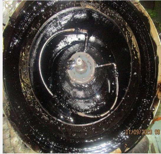
Kararsız yakıt, tortu ve asfaltten çökeltilerine bağlı çamur sorunları
