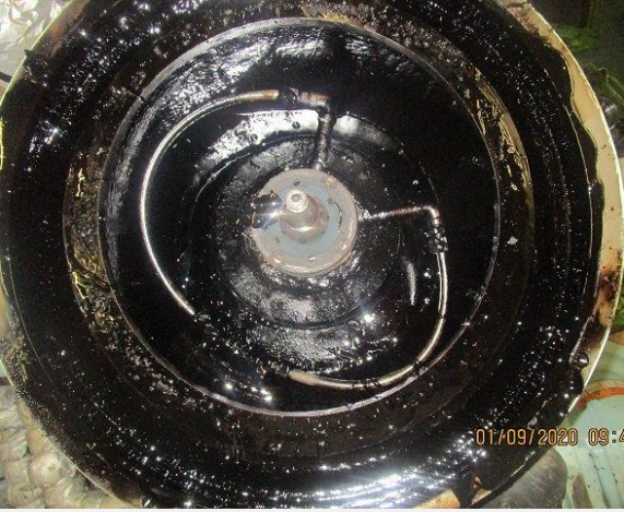
Kararsız yakıt, tortu ve asfaltin çökeltilerine bağlı çamur sorunları
